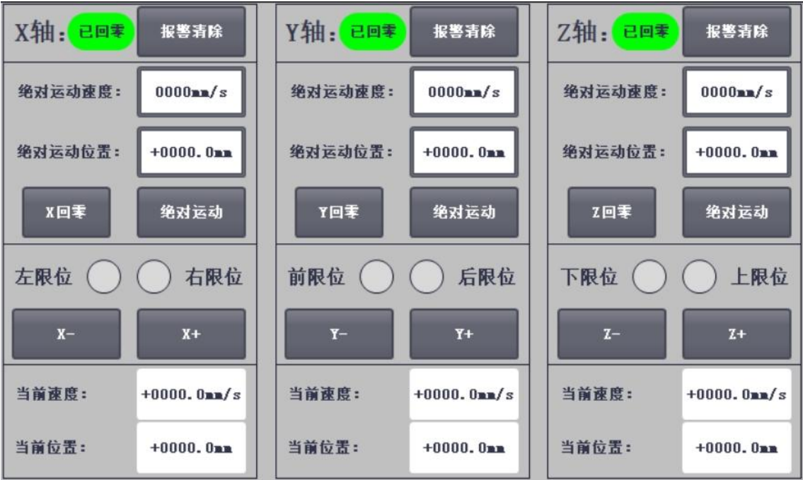
图 3 智能仓储机器人各轴功能调试参考界面
